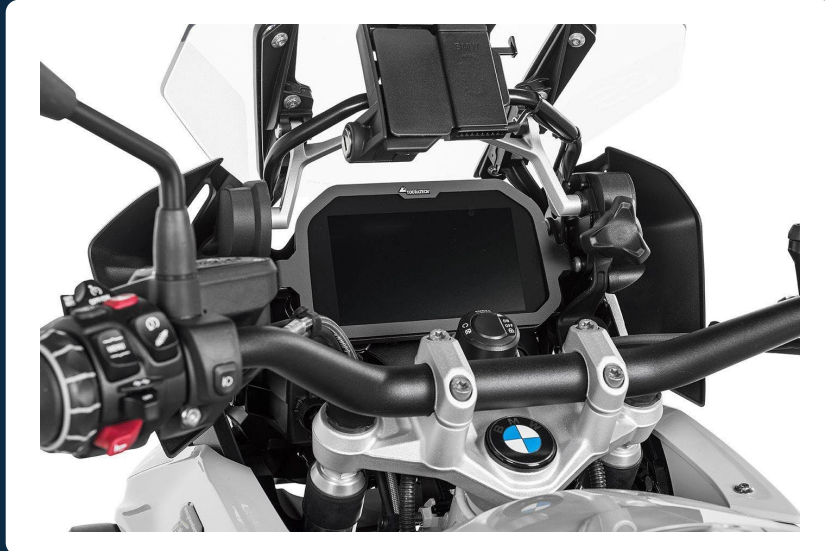
Der BMW-Motorrad-Multimediacontroller in Einbaulage am Lenker (Quelle: Touratech)
