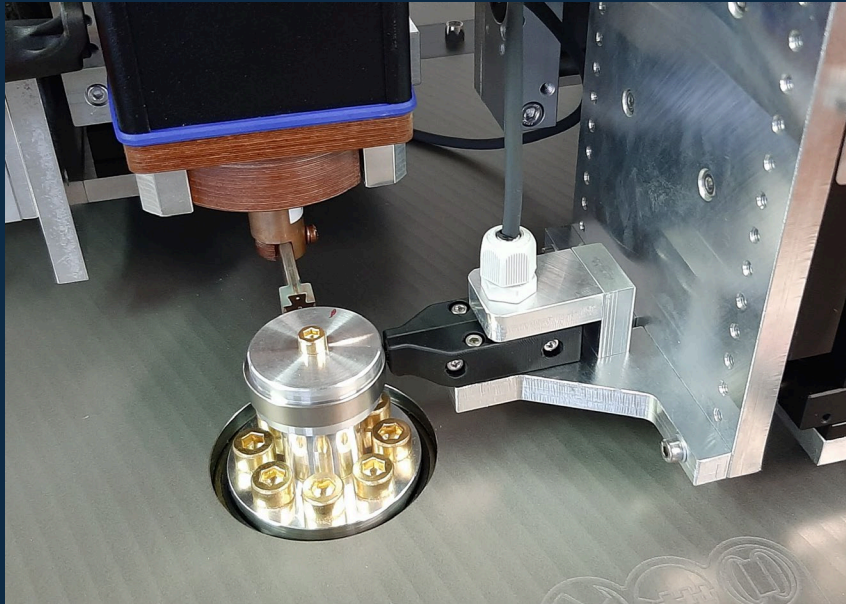
Magnetring in der SL01 Messen und Magnetisieren
