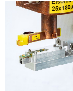
Schreibspule mit Kupferplatten zur Wärmeabfuhr
