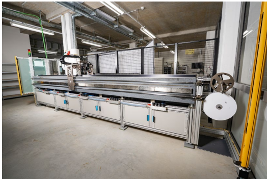
LMP5000 — 5000 mm Schreiblänge, im Fertigungsbereich bei ITK
