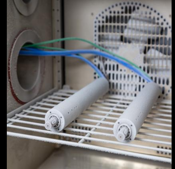
Temperatur Test: -130° C bis +200° C (inhouse)
