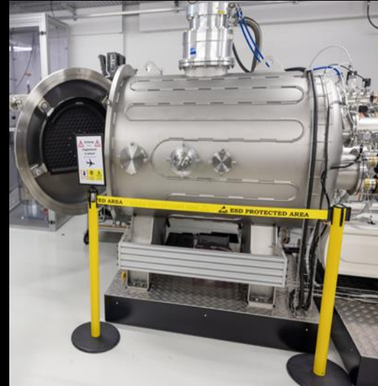
Vakuum Vakuumtest bis 10^{-7} bar (inhouse)
