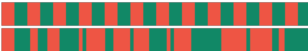
Abbildung 7.12: Spurtypen – Inkrementalspur mit Pseudorandomcode I24:P
