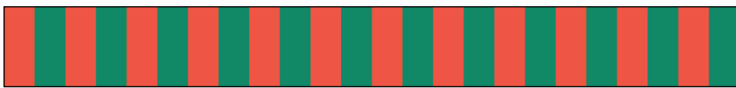
Abbildung 7.4: Spurtypen – Inkrementalspur I24
