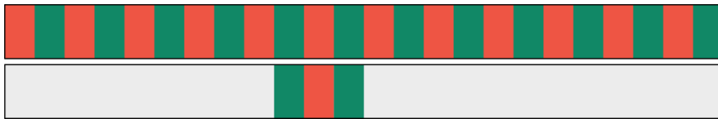
Abbildung 7.9: Spurtypen – Inkrementalspur mit Referenzspur I24:R1
