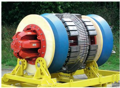
Abb.: Molch für Rohr-Inspektion
