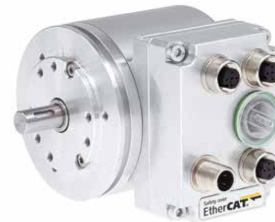
Sicherer Drehgeber (SIL3) mit betauungs-sicherer, magnetischer Doppelabtastung.
