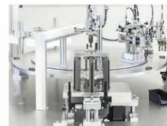
AMP - das vollautomatische Magnetmesssystem
